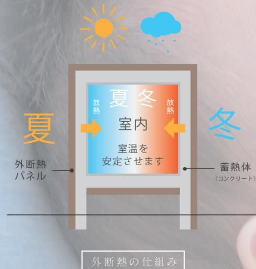
外断熱の仕組み
